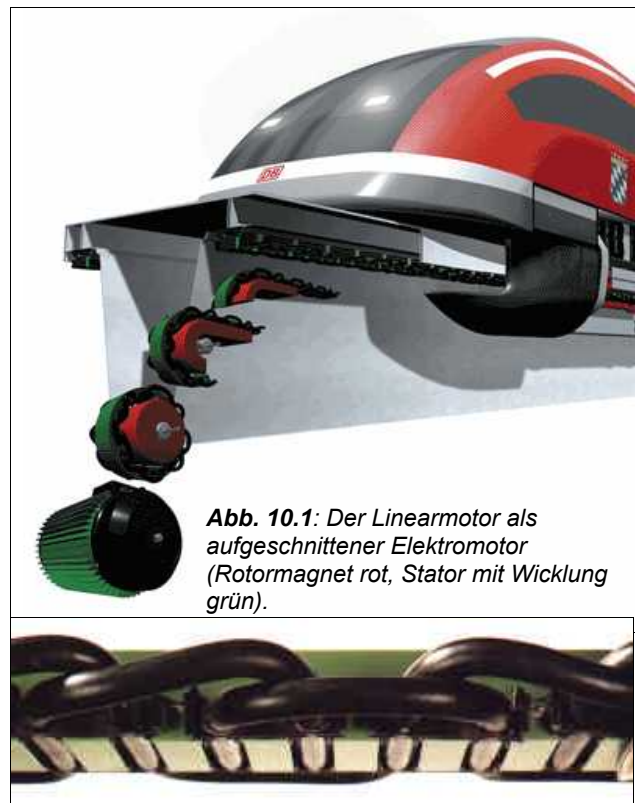
Abb. 10.2: Blick von schräg unten auf den Stator, in dessen Nuten die Wanderfeldwicklung befestigt ist.
