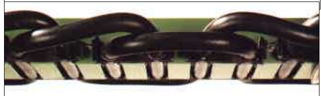
Abb. 10.2: Blick von schräg unten auf den Stator, in dessen Nuten die Wanderfeldwicklung befestigt ist.
